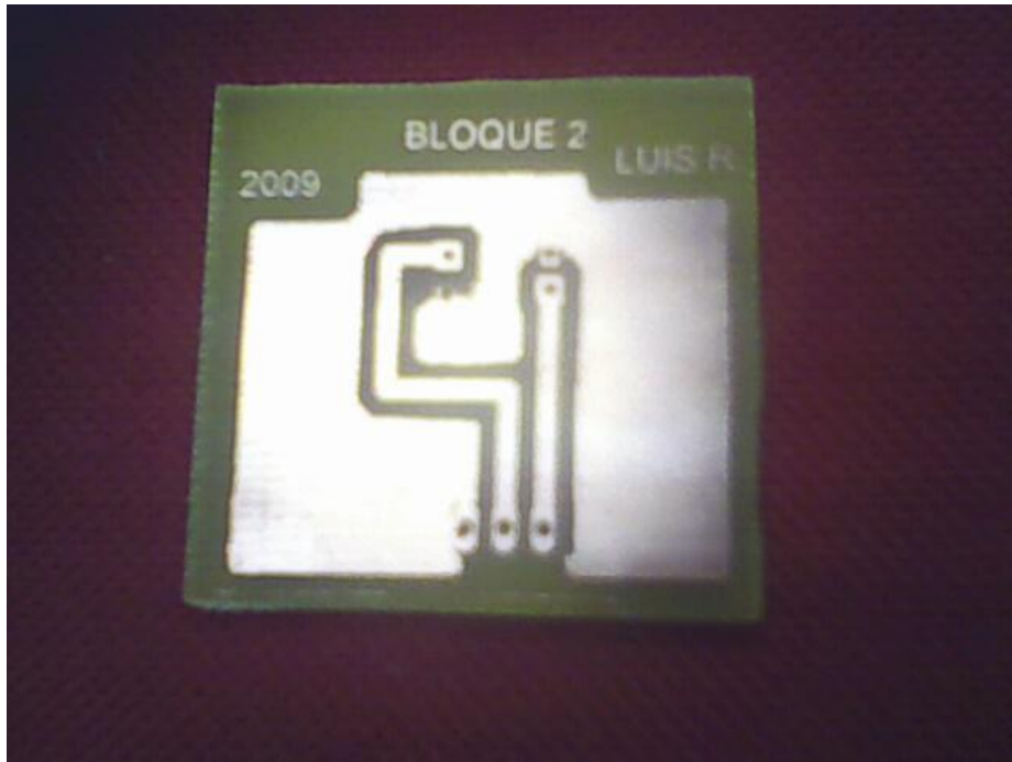
Figura 3.9 Cara Posterior Circuito Impreso Bloque #2 (baquelita)
