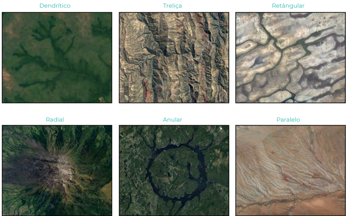
Figura 2 A disposição espacial dos principais tipos de padrões de drenagem. Fonte: Siqueira et al. (2018)
