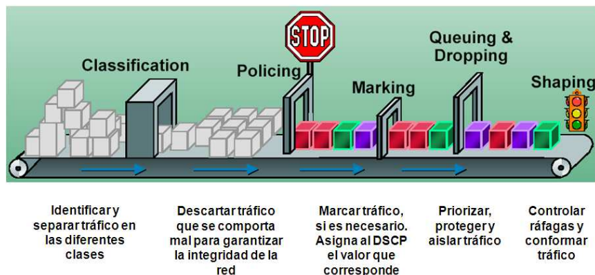
Figura 1.11 Implementación de DiffServ en los Routers (Pontificia Universidad Católica de Chile, Escuela de Ingeniería, 2009)
