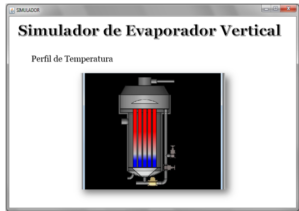
Figura 6: Perfil de temperatura del fluido que circula por el interior de los tubos
