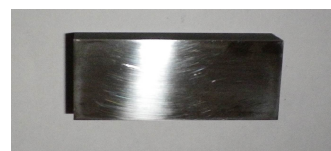
(a) Probeta A usada para el ensayo de picadura, de 20x50 mm, con espesor de 10 mm
