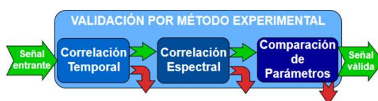
Figura 9: Método de validación experimental.
