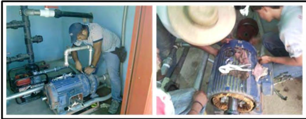
**Figura 5.19. Desarme de la bomba averiada.**
