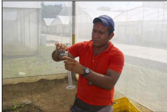
**Figura 6.10. Medición del volumen colectado de los emisores.**
