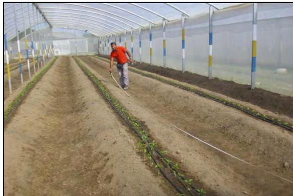
**Figura 6.8. Medición de las distancias de los emisores colocados a  $1/3$  y a  $2/3$  del inicio.**
