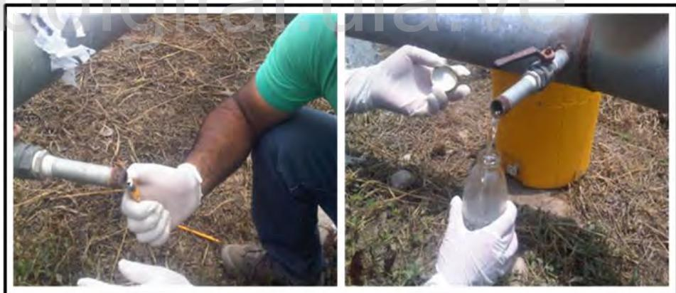
**Figura 5.6. Flameada de la tubería y recolección de la muestra.**
