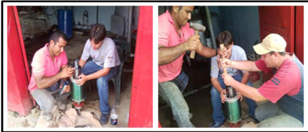
**Figura 5.21. Instalación del nuevo rodamiento al eje.**
