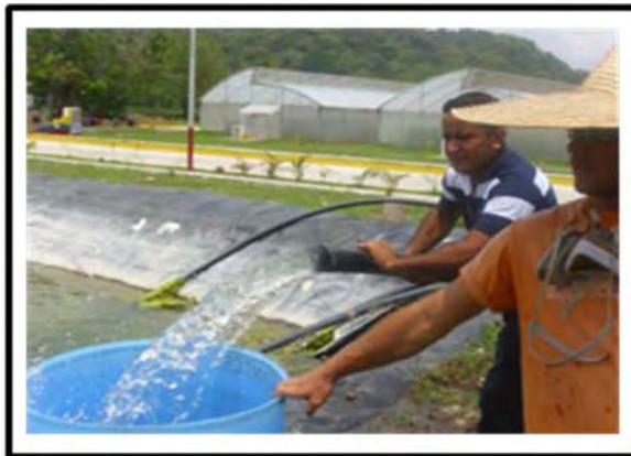
**Figura 6.3. Chequeo del caudal de descarga del sistema de bombeo.**
