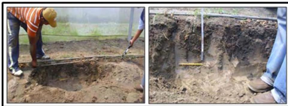
**Figura 6.12. Medición del diámetro de humedecimiento y la profundidad**
