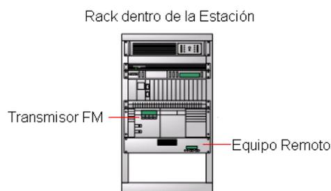
**Figura 4.1 Disposición Física del Equipo Remoto**
