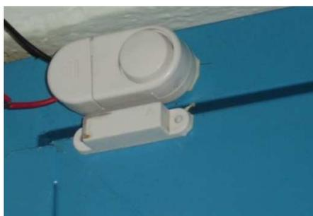
**Figura 4.18 Sensor de Puerta Abierta/Cerrada Instalado**
