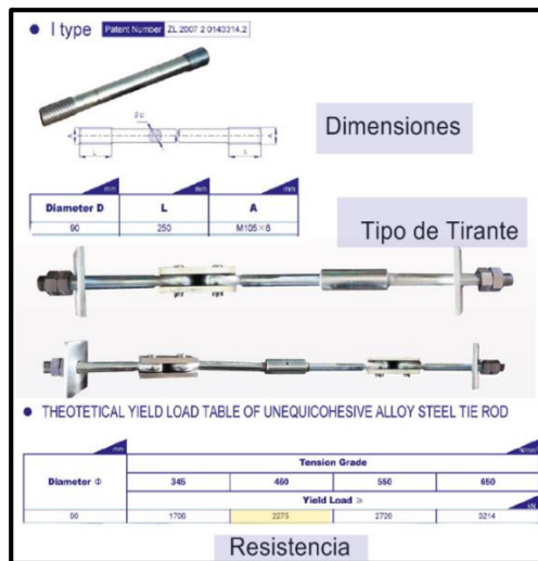
Fig 19. Tirante de acero o Péndola: del catálogo de la empresa INPROCON, para el elemento escogido de diámetro 90mm, se tiene que la rosca tiene una longitud de 250mm, y corresponde a una de tipo M105x6; asimismo la resistencia del cable es 2275KN cada uno. Tomado de INPROCON
