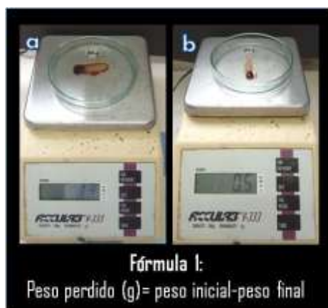
Figura 3. Pesaje del coágulo de FRP. a) Peso inicial. b) Peso final. Fuente propia.
