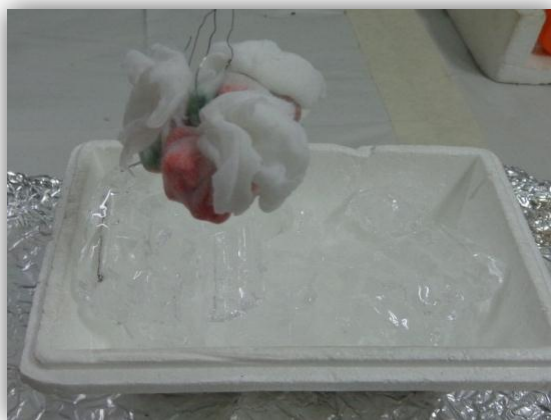
Figura 15. Termociclado temperatura 5° C.
