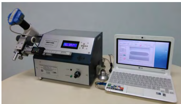
Fig. 13. Reómetro interfacial de gota giratoria desarrollado en colaboración con el CITEC-ULA
