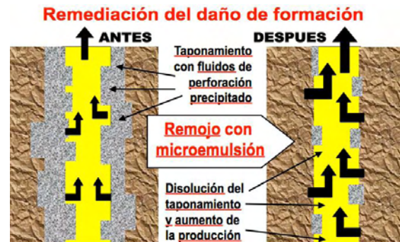
Fig. 12. Remediación de daños de formación usando microemulsiones
