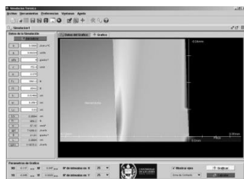
Fig. 9. Gráfica de la zona de deformación secundaria (Fuente propia).
