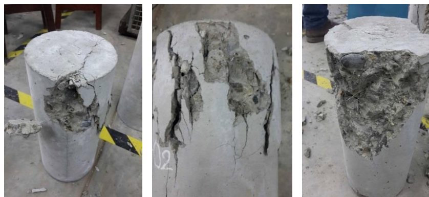
Figura 3. Fractura de probetas según la carga utilizada. Fuente: los autores
