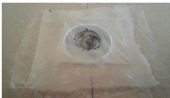
Figura 12. Sensor protegido con una membrana elástica delgada. Fuente: [7]
