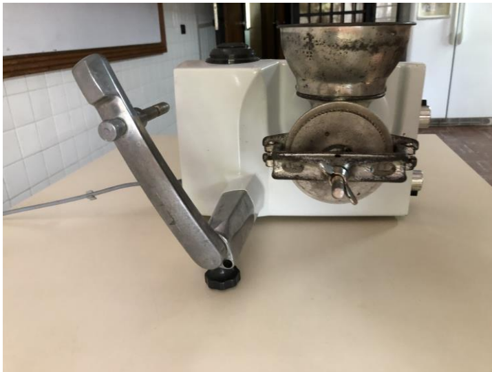
Anexo 7: Molino de Discos utilizando para la primera molienda
