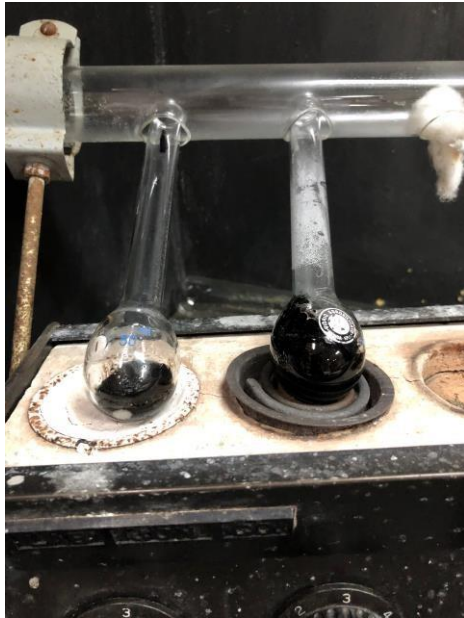
Anexo 19: Aparato digestor para el método de microkjeldahl.
