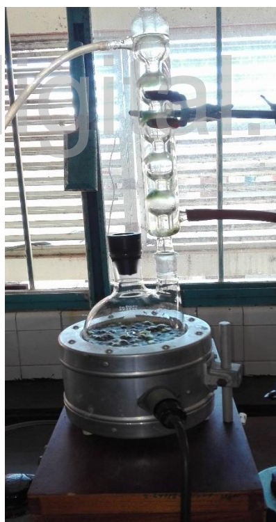
Figura 5. Obtención del extracto de Stevia rebaudiana mediante el equipo de extracción a reflujo.
