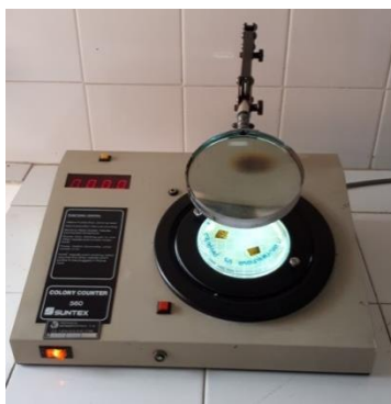
Imagen 8 Observación de halos de inhibición con el contador de colonias. Fuente: Propia.
