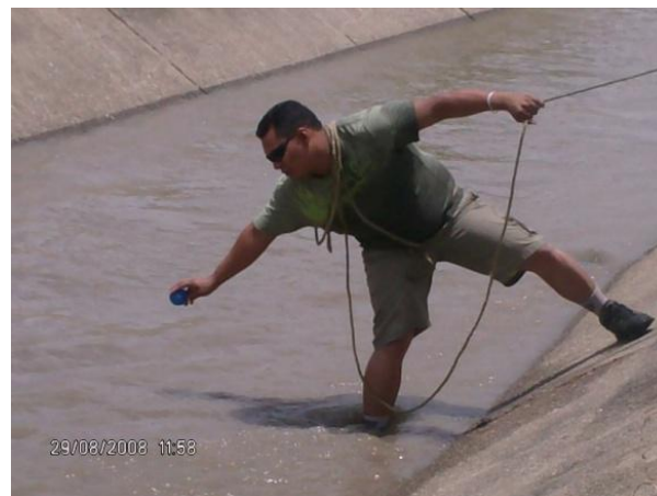
Figura 4.61 Aforo en el canal principal sección trapezoidal
