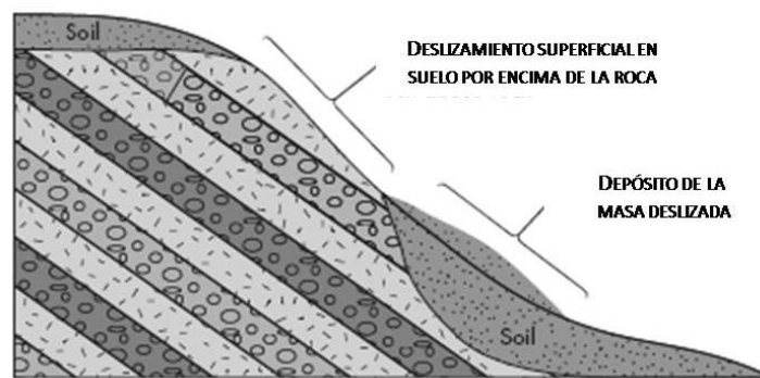
Figura 8. El espesor del suelo por encima de la roca sana (perfil de meteorización) determina el volumen de material susceptible de ser movilizado. Modificado Keller y De Vecchio, 2012.
