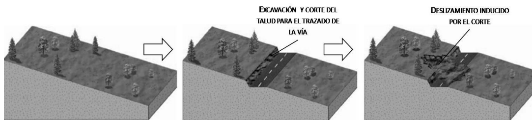
Figura 2. Las excavaciones para el trazado de carreteras pueden alterar el equilibrio de un talud. La remoción de su soporte en la base, así como el aumento de la pendiente en el punto de excavación pueden resultar en la ocurrencia de deslizamientos a lo largo de la vía. Modificado de Wicander y Monroe, 2009.
