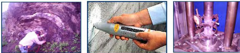
Figura 13. Toma de muestras, medición con esclerómetro in situ y ensayo de compresión uniaxial. Imágenes tomadas de Quintero y Elberg [6].
