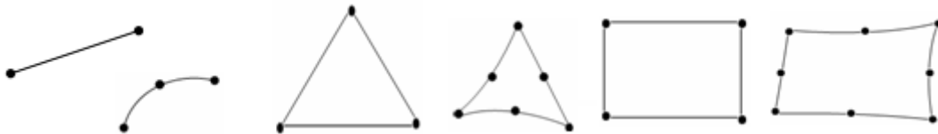
Figura 5. Elementos unidimensionales de dos y tres nodos y elementos bidimensionales de tres, seis, cuatro y ocho nodos.
