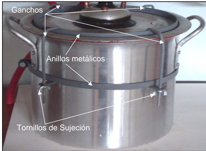
Figura 4. Anillos metálicos, ganchos y tornillos de sujeción del bioreactor.
