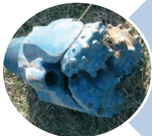
Figura 2.13. Tricono. Fuente: Collazo (2012)
