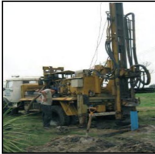
Figura 2.15. Máquina perforadora. Método de rotopercusión. Fuente: Collazo (2012)
