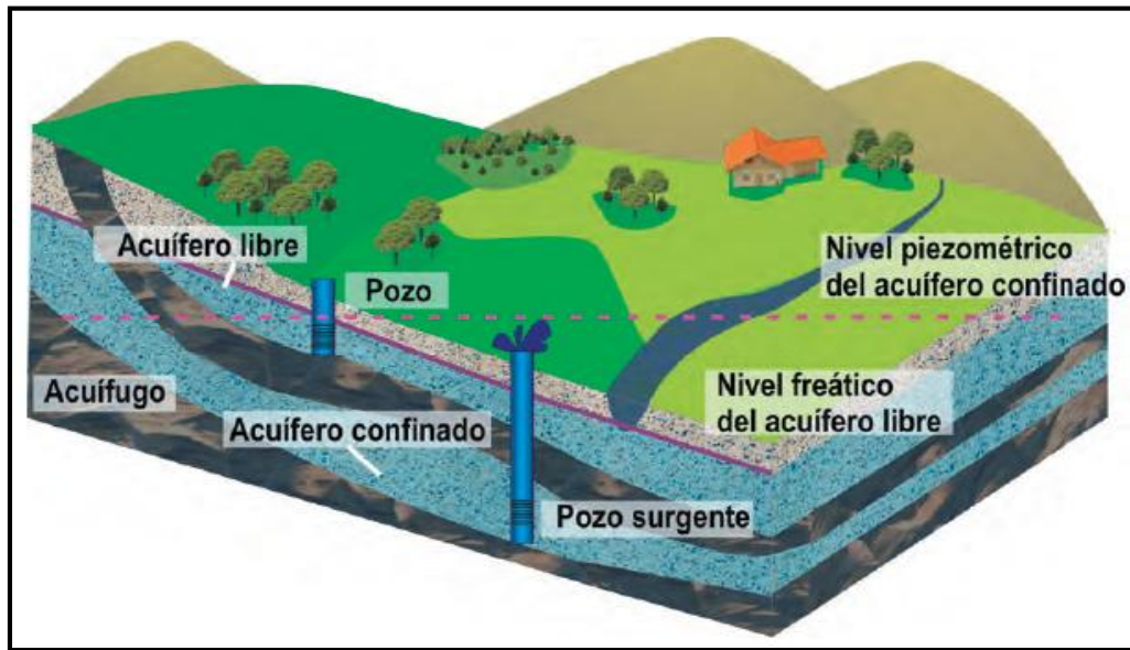
Figura 2.6. Pozos en acuífero libre y confinado. Fuente: Collazo (2012)
