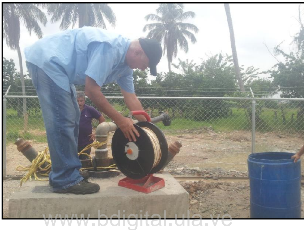
Figura B.1. Sonda empleada para determinar los niveles estático y dinámico en el pozo de estudio
