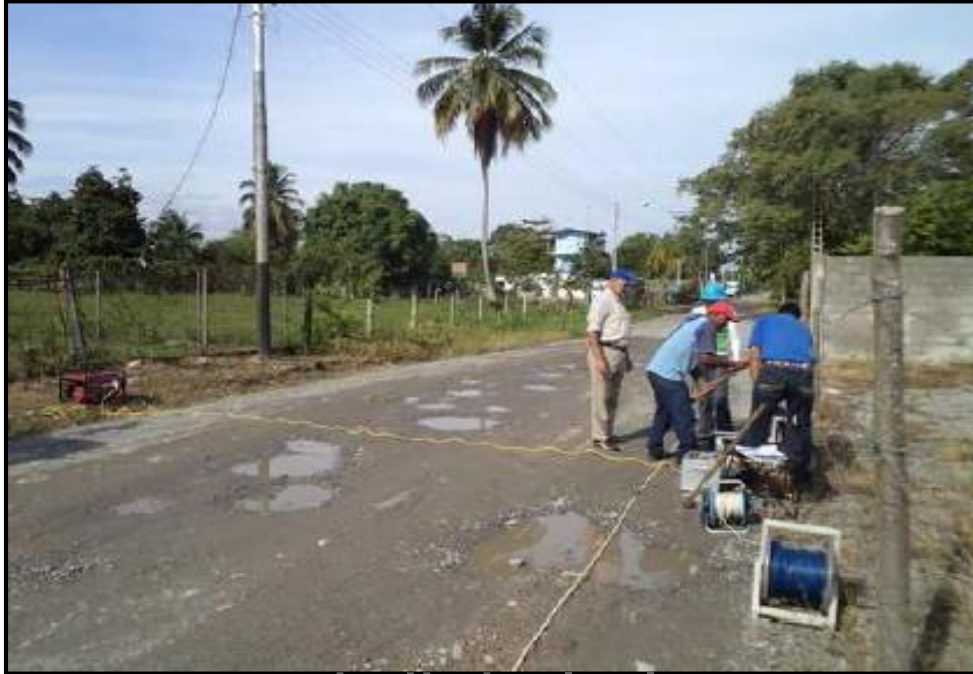
www.bdigital.ula.ve Figura A.1 Colocación de los electrodos para la ejecución del SEV
