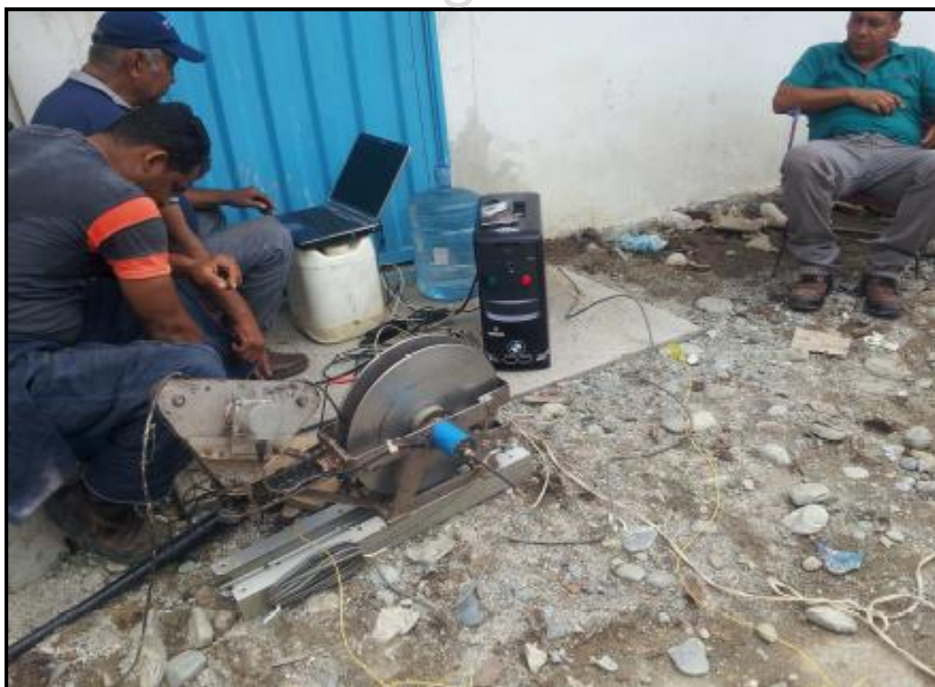
Figura B.2. Ejecución del registro eléctrico
