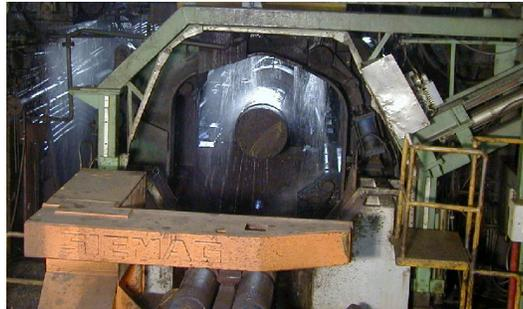
**Figura 6. Enrollador n °1 del laminador en caliente de SIDOR**
