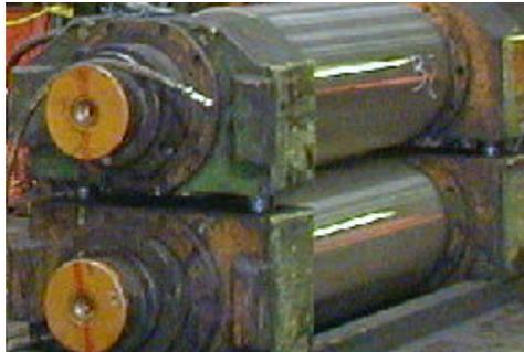
**Figura 9. Cilindros de trabajo utilizados en tren continuo de laminación en caliente de SIDOR**
