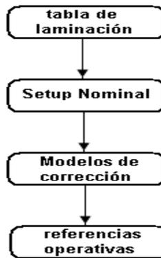
**Figura 13. Flujo de procesamiento de variables para la obtención de referencias operativas del tren continuo.**
