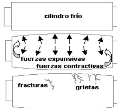
**Figura 23. Desgaste por fatiga térmica**
