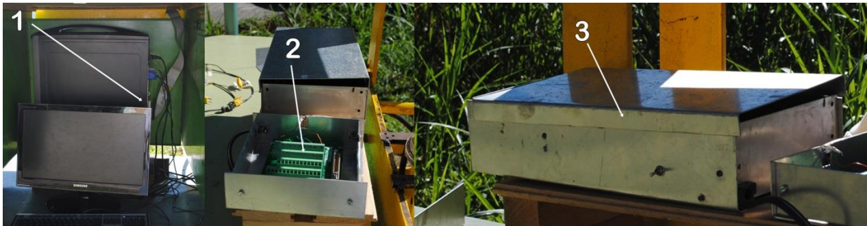
Figura 24. Sistema de Adquisición de Datos: 1) Tarjeta de Adquisición de Datos inserta en el computador, 2) Bornera, 3) Sistema de Amplificación de la Señal proveniente de las termocupas.
