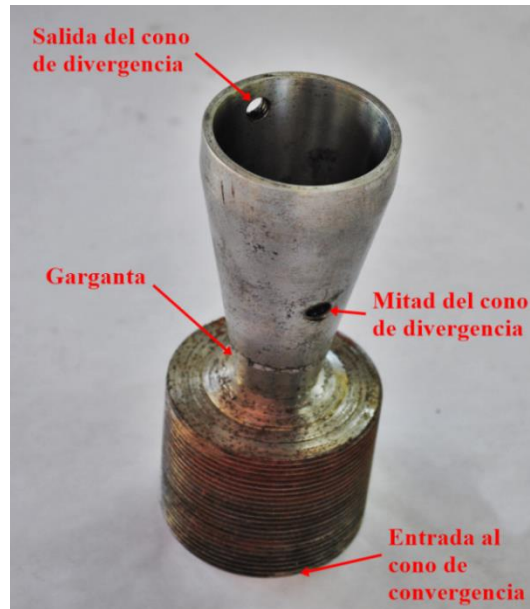
Figura 23. Localización de las cuatro termocuplas en la tobera. Termocupla 1: Entrada al cono de convergencia – Termocupla 2: garganta – Termocupla 3: Mitad del cono de divergencia – Termocupla 4: Salida del cono de divergencia.
