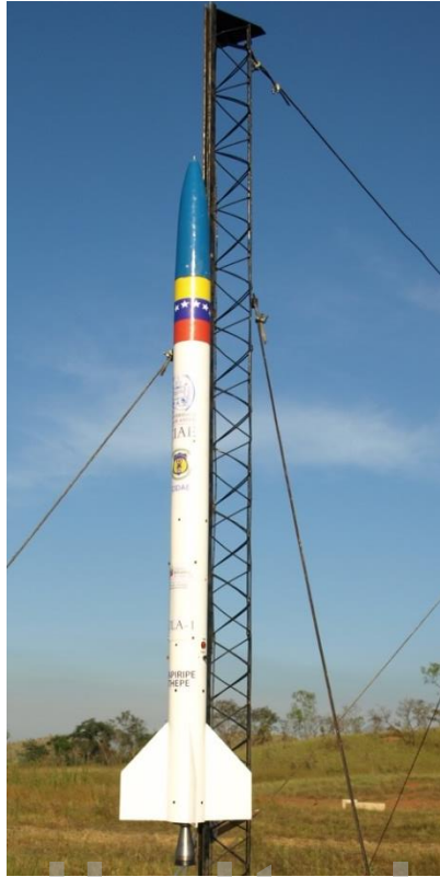
Figura 1. Cohete ULA-1B instalado en lanzadera, previo a prueba de rendimiento aerodinámico en El Pao, estado Cojedes (26-11-2011).
