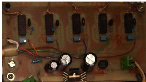
Figura 25. Tarjeta amplificadora de la señal de las termocupas tipo K, elaborado en los laboratorios de la Universidad de Los Andes para medir temperaturas en el motor ULA-1A.
