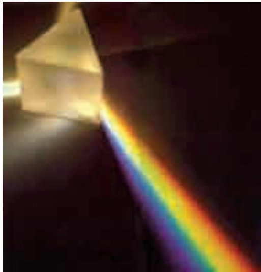
Figura 1.1 La luz blanca y sus colores constituyentes al pasar a través de un prisma.
