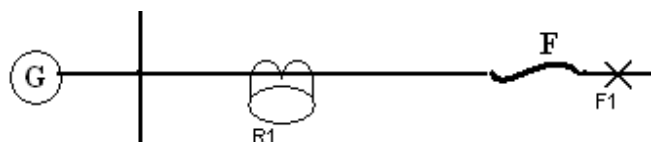
Figura 2.9 Esquema de coordinación relé-fusible
