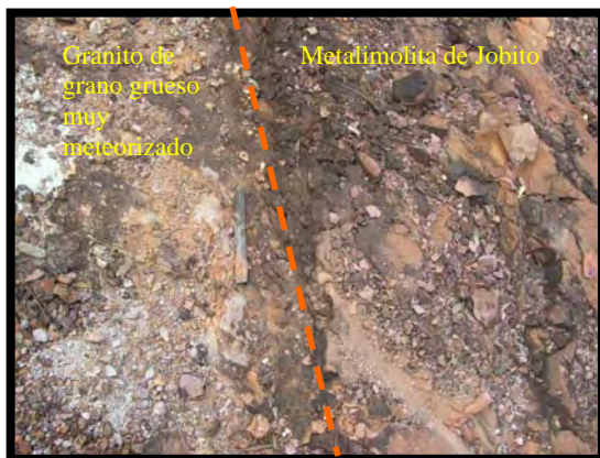
Traza de falla poniendo en contacto el granito muy meteorizado con la metalimolita (P-135).
