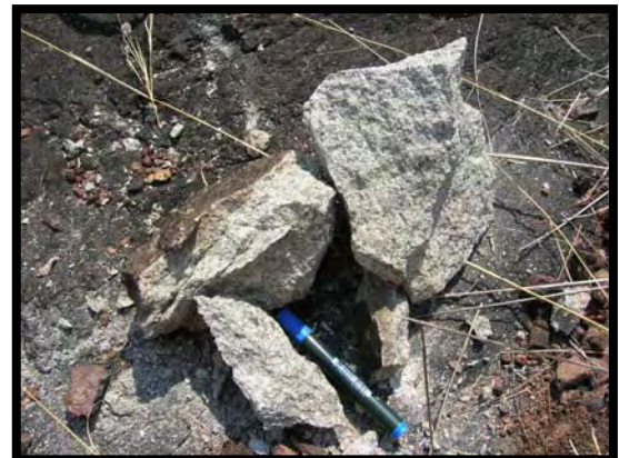
Afloramiento y fragmentos de granito muy meteorizado de color gris (P-129).
