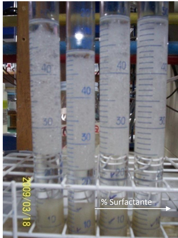
Figura 58: Barrido con bentonita tipo A y Prepagen WK-V, tras un lapso de tiempo de 25 horas.
