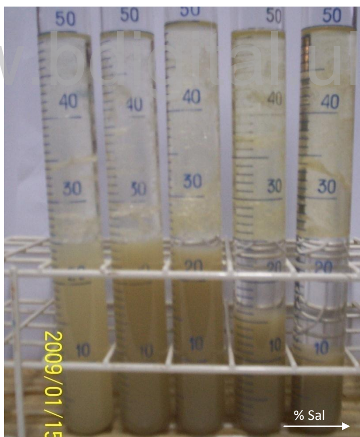
Figura 50: Barrido de salinidad con bentonita tipo C, tras un lapso de tiempo de 24 horas.
