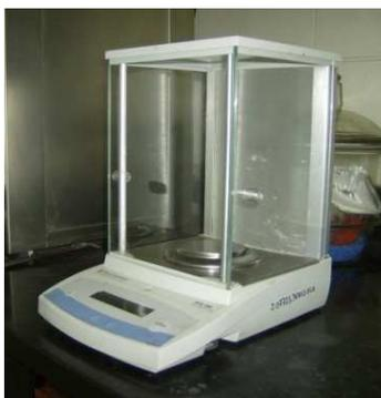
**Figura IV.1.** Balanza Analítica Digital.
