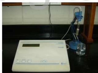
**Figura IV.8.** Equipo de Medición de pH.
