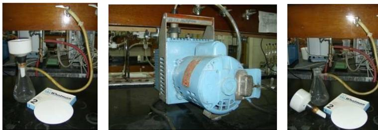
**Figura IV.6.** Equipo de Filtración con Papel Filtro.
